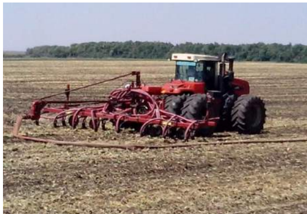
Рис. 4.49. Дозированное внесение животноводческих стоков в почву
